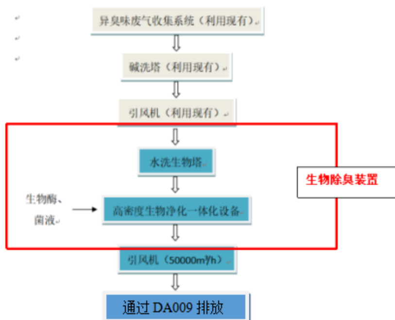
图 3.5-2 生物除臭装置废气处理工艺图
